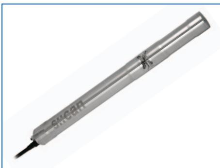
s::can spectro::lyser 是浸没式紫外可见光谱仪，可测量200-750nm的吸光度。s::can特有的专利逻辑分析和光谱数据分解技术能测量许多重要的污水参数提供，包括：硝酸盐、亚硝酸盐、COD、BOD、TSS和H<sub>2</sub>S。浸没的部分没有可拆卸的部件，无须试剂。
