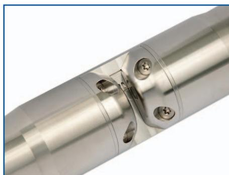
Le spectro::lyser™ de s::can est un spectromètre UV-Vis entièrement submersible qui mesure l'absorbance de la lumière entre 220 et 380 nm. Les algorithmes propriétaires de s::can, analysent et décomposent les données spectrales pour fournir des mesures pour de nombreux paramètres des eaux usées, y compris: nitrate, nitrite, DCO, DBO, TSS et H<sub>2</sub>S dissous. Aucune pièce mobile n'est en contact avec l'eau et aucun réactif n'est utilisé, ce qui réduit les coûts d'exploitation.
