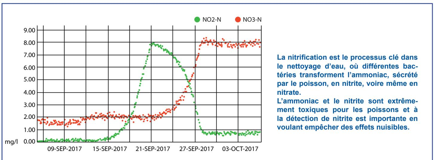
La nitrification est le processus clé dans le nettoyage d'eau, où différentes bactéries transforment l'ammoniac, sécrété par le poisson, en nitrite, voire même en nitrate. L'ammoniac et le nitrite sont extrêmement toxiques pour les poissons et à la détection de nitrite est importante en voulant empêcher des effets nuisibles.
