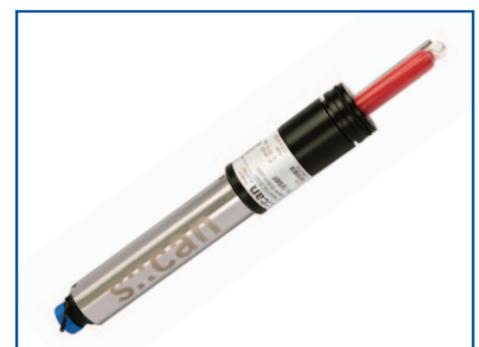
Le pH::lyser est une sonde multi-paramètres qui mesure la valeur du pH et de la température directement dans l'eau. Le pH::lyser utilise la température pour corriger le résultat de la mesure du pH en ligne. L'électrode de référence, non poreuse et résistante, assure d'excellentes lectures pH et une longue durée de fonctionnement de l'électrode particulièrement dans des environnements difficiles.
