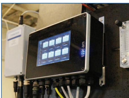
Le con::cube est un terminal Versatile compact pour l'acquisition de données. Intégrant la technologie de processeur la plus récente, le con::cube est très flexible, options pour l'interfaçage avec SCADA ou tout autre système de base de données centrale, fournissant une solution parfaite pour le contrôle de la station. Affichage jusqu'à 64 canaux/paramètres.
