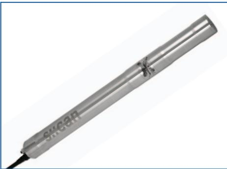
Der spectro::lyserTM ist ein UV-Vis Spektrometer, welcher die Absorption im Bereich von 190 – 750 nm misst. Algorithmen berechnen aus den spektralen Rohdaten Wasserqualitätsparameter wie z.B. Nitrat, Nitrit, CSB, BSB, H<sub>2</sub>S etc. Im spectro::lyser sind keine beweglichen Teile verbaut. Da es sich um ein rein optisches Messgerät handelt, kann auf Reagenzien verzichtet werden - dies führt zu extrem niedrigen Betriebskosten.
